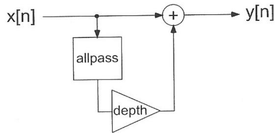
Der *Chorus Effekt* lässt einen Musiker so klingen, als ob mehrere Musiker dieselben Noten spielen würden. Dazu wird das Eingangssignal durch mehrere FIR Filter gefiltert. Die jeweiligen Ausgangssignale werden zum Eingangssignal wiederum addiert:
