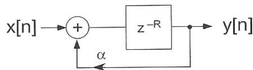
Hierbei wird nicht das verzögerte Eingangssignal für die Berechnung herangezogen, sondern das verzögerte Ausgangssignal. Um Stabilität zu gewährleisten sollte der Verstärkungsfaktor kleiner als 1.0 gewählt werden.
