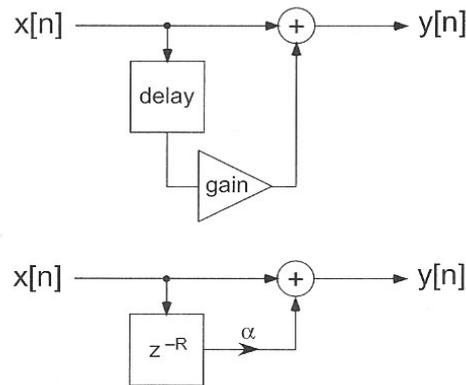
Das eingehende Signal wird mit einem skalierten, verzögerten Signal addiert. Die Verzögerung ist konstant und ergibt in Relation mit der Abtastrate die Zeit nach der das Echo auftritt.
