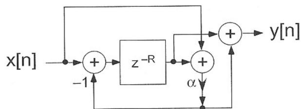
Für den Phaser Effekt muss jedoch eine sich langsam verändernde Verzögerungszeit verwendet werden. Eine Sinusfunktion mit einer Frequenz von 1 Hz scheint angebracht zu sein. Dieser allpass Filter kann nun für den Phaser Effekt verwendet werden. Die Ausgabe des allpass Filters wird dabei skaliert zum Eingangssignal hinzuaddiert:
